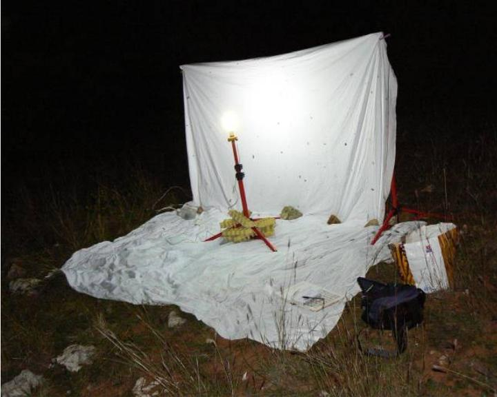
**Photo 1** : dispositif de capture avec lampe à vapeur de mercure 80 W (Jérôme ROBIN).
